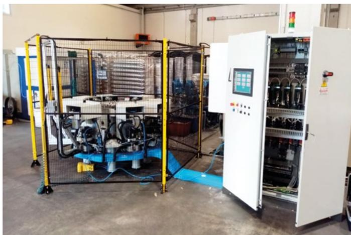
impianto di foratura per cerchi di biciclette in alluminio con diametro da 20" a 29". L'impianto è dotato di nr.8 unità di foratura indipendenti tra loro e autoregolabili con elettromandri che possono lavorare fino a 24.000giri: anziché dover settare l'inclinazione e la profondità di foratura per ogni modello di cerchio da lavorare, con questa macchina è possibile modificare i gradi di foratura, l'altezza e la profondità senza dover spostare le unità.
