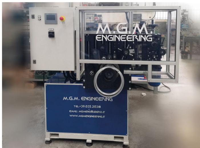
impianto per la calandratura delle barre estruse di alluminio da 14" a 29". Il cambio del diametro di lavorazione avviene tramite cambio della ruota di calandratura e regolazione manuale dei contrasti.
