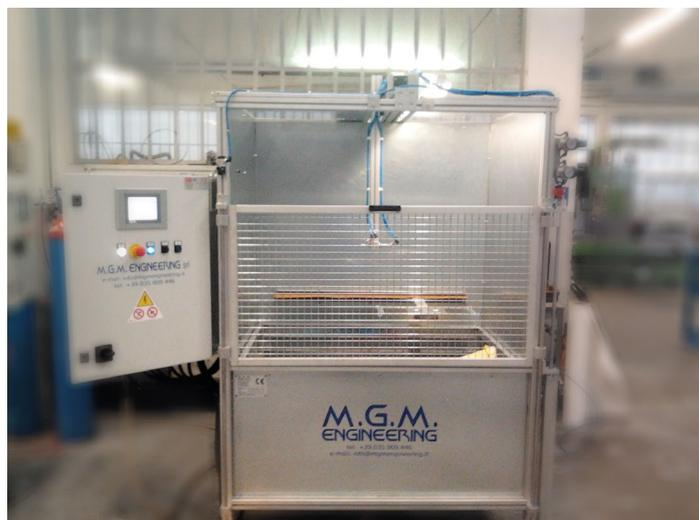
cabine di verniciatura particolari complete di movimentazione orizzontale o verticale tramite assi lineari e motori Brushless certificati Atex.
